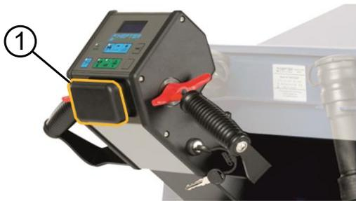
Der Rückfahr-Sicherheitsschalter **(1)** bewegt bei Betätigung die Maschine ca. 50 cm vom Bediener weg, um den Bediener aus dem Gefahrenbereich zu bringen.
