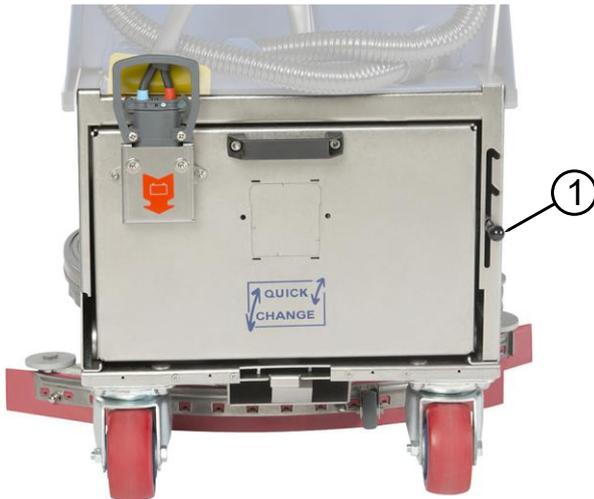
1. Den Hauptsaugleistendruck auf den maximalen Wert stellen.
